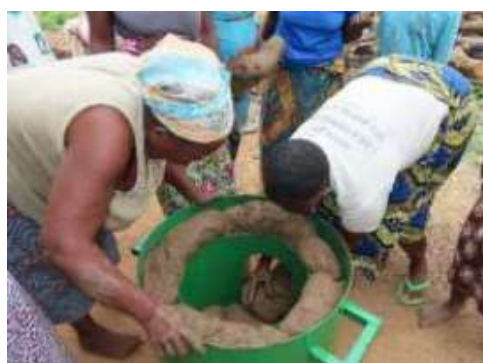
Figure 5 : Fabrication d'un foyer à usage productif par un groupement de femmes
